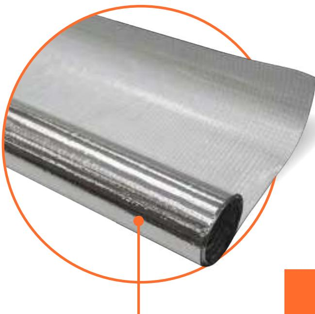
Отражательный теплоизоляционный материал, состоящий из алюминиевой фольги, сдублированной со стеклосеткой. Поверхность алюминиевой фольги защищена полиэтиленовым покрытием. Выпускается типов: A, B, C.
