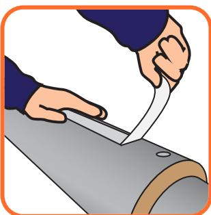
Проклейте швы самоклеящейся алюминиевой лентой ЛАС-П таким образом, чтобы лента закрывала заклепки и нижний слой на 10-15 мм.
