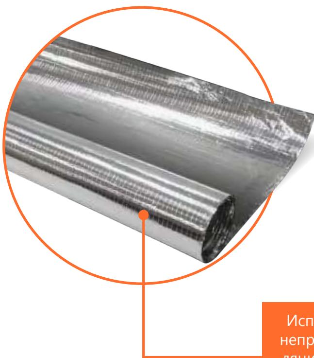
Отражательный теплоизоляционный материал, состоящий из двух слоев алюминиевой фольги, сдублированных со стеклосеткой. Дополнительный слой фольги позволяет эффективно применять материал в конструкциях с двумя воздушными прослойками (отражать тепловой поток в обе стороны).
