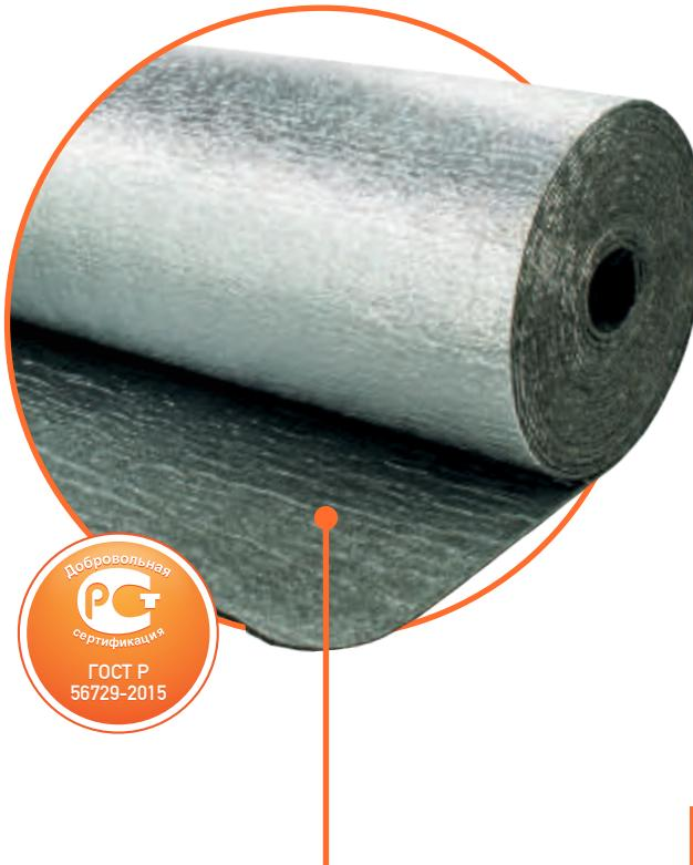
Самоклеящийся материал из вспененного полиэтилена черного цвета с закрытой ячеистой структурой, с одной стороны имеет антиадгезионное покрытие. Блэк Стар Дакт АЛ дополнительно дублирован с другой стороны полированной алюминиевой фольгой.
