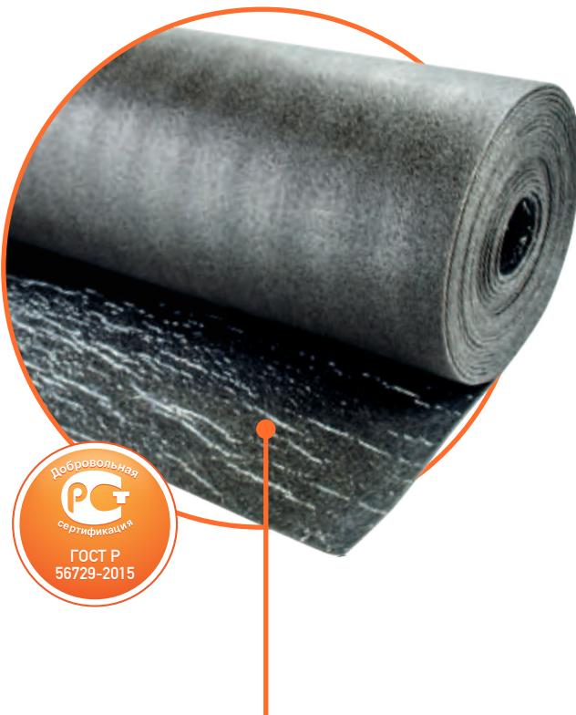
Самоклеящийся материал из вспененного полиэтилена черного цвета с закрытой ячеистой структурой, с одной стороны имеет антиадгезионное покрытие.
