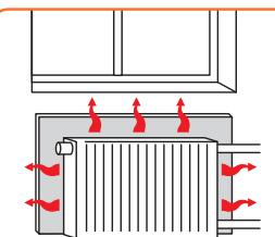
Отражательный экран радиаторов отопления.
