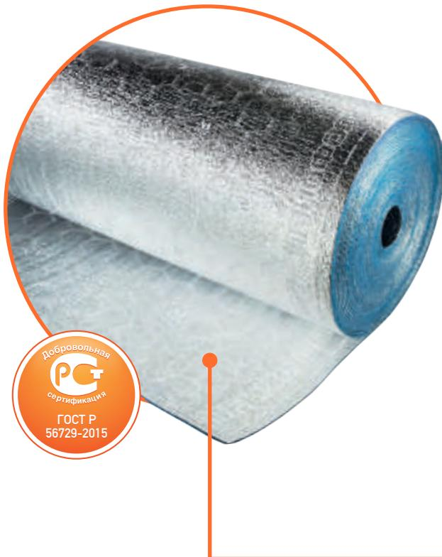
Материал из вспененного полиэтилена голубого цвета с закрытой ячеистой структурой, дублированный с обеих сторон полированной алюминиевой фольгой с защитой от подделок – универсальной печатью – на внешней стороне. Дополнительный слой фольги позволяет эффективно применять материал в конструкциях с двумя воздушными прослойками (отражать тепловой поток в обе стороны).
