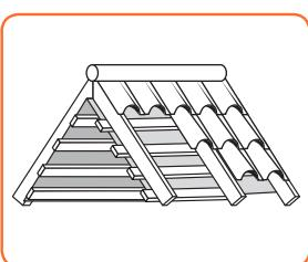
Тепло-, пароизоляция подкровельного пространства.
