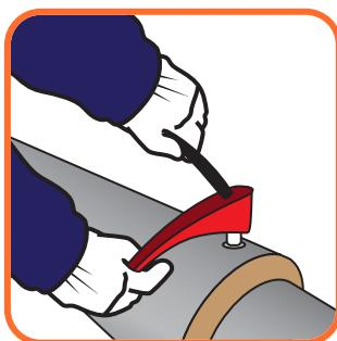
Задейте заклепку с помощью ручного заклепочника.
