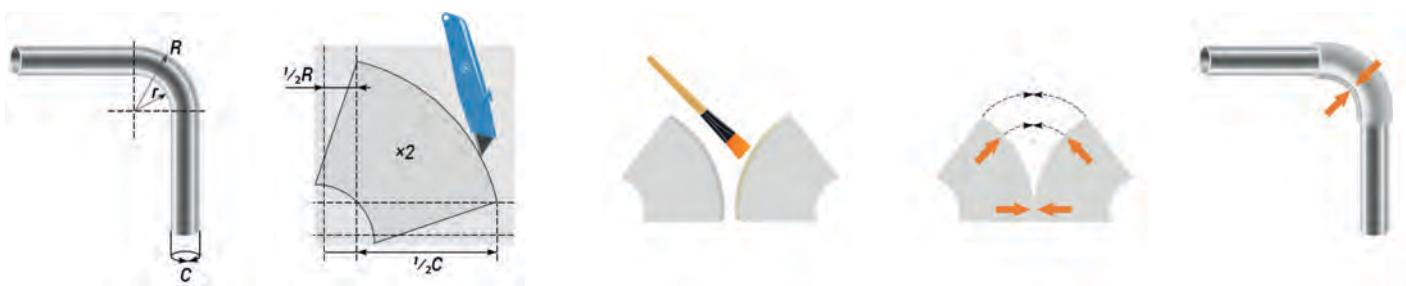
Благодаря высокой гибкости **ТИТАНФЛЕКС®** легко монтируется и применяется на участках разной геометрической формы. Это позволяет устанавливать материал без особых трудоемких затрат и в короткие сроки. В то же время, материал упругий и после установки имеет красивый эстетический вид. Для удобства использования разработано специальное руководство по монтажу материала.
